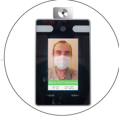
Kızılötesi Yüz Tanıma ve Maske Kontrol Sistemli Termometre Opsiyonu
